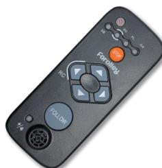
追従モードの発信部とラジオコントロールモードのリモコン、二つの機能を兼備。
